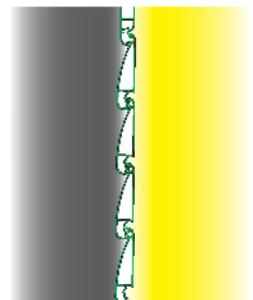
Il disegno delle lamelle assicura una chiusura perfetta. In abbinamento allo spazzolino risolve la criticità della luce ritrissa sulle finiture di colore chiaro.
